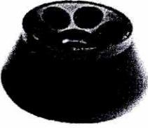
Tubos: 85 ml, tubos de microcentrifuga.<br>Velocidad max.: 15.500 rpm<br>Fuerza max.: 26.320 x g.  | 3,514.00 | 3,514.00        |
